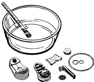
Manuelle Reinigung der zerlegten Kühleinheit
